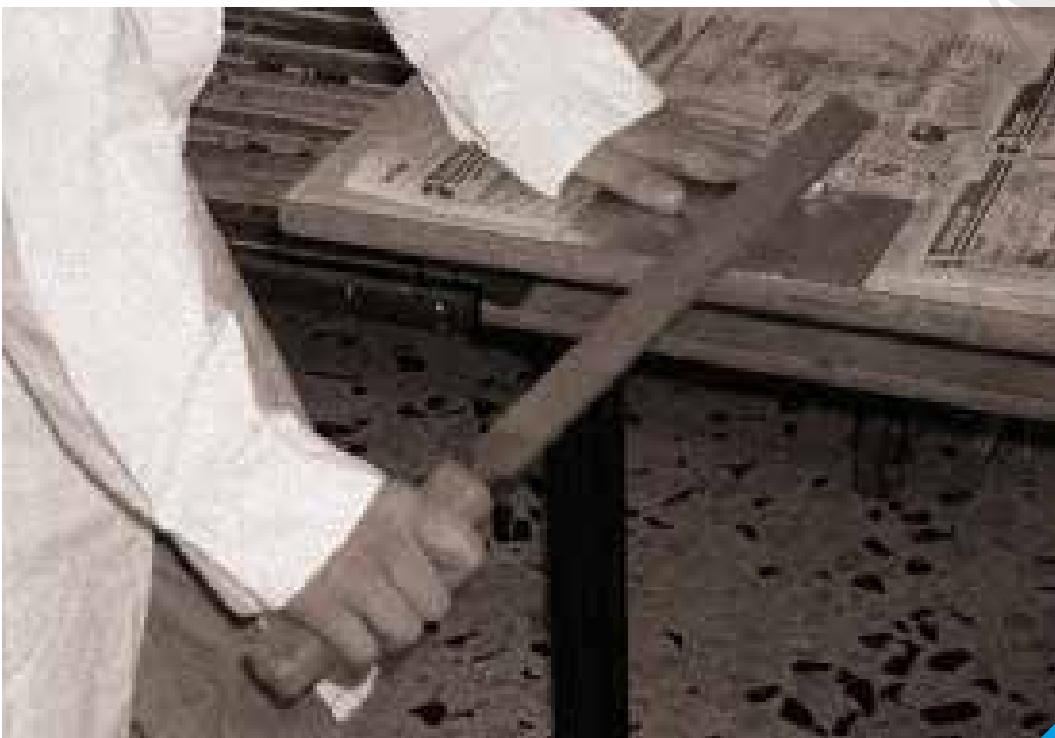
Smussatura dei bordi e messa in sicurezza della lastra
