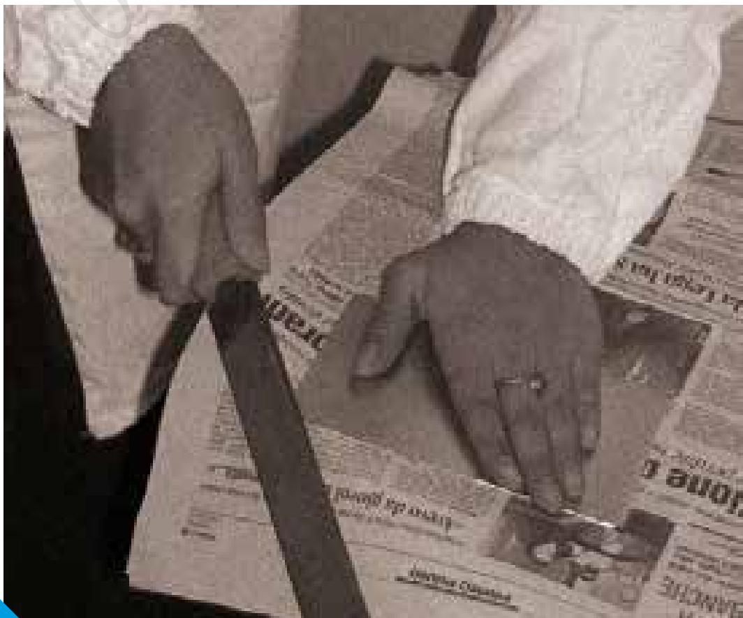
Smussatura degli angoli e messa in sicurezza della lastra
